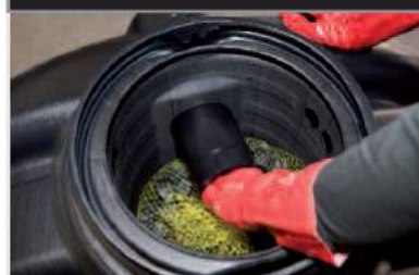
3 - Retirer le manchon amovible de connexion en tirant sur sa poignée.
