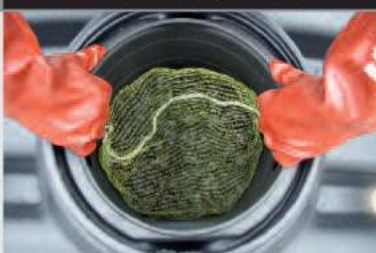
4 - Extraire le préfiltre indicateur de colmatage intégré en le soulevant, mains tournées vers l'extérieur
